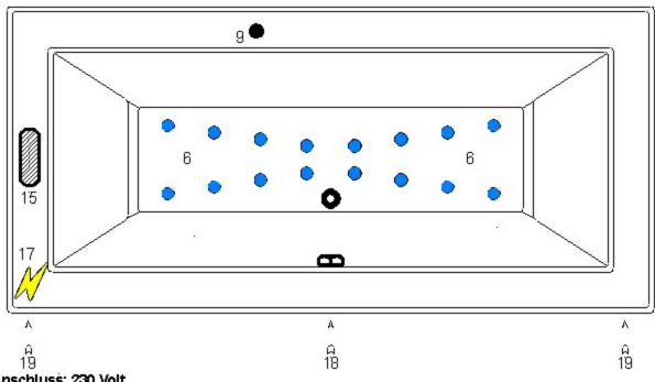
Anschluss: 230 Volt 3 x 1,5mm Querschnitt mit 16 Ampere Absicherung in diesem Bereich
