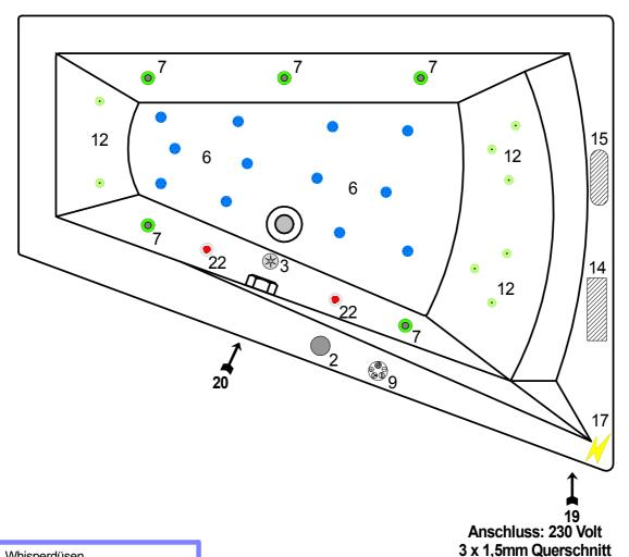
25 Whisperdüsen 1 Lichttherapie 2 Luftregler 3 \* Seitenansaugung Zweiwegeventil 4 5 Champagner Airdüsen 6 7 0 Wasserdüsen Unterwasserscheinwerfer 8 9 Bedientaster: Whirlpool Komfortschalter drehbar 10 🗖 0 Bedientaster: Farblichttherapie **P** 12 • Microjetdüsen 21 (%) Bedientaster: Frischwasserspülung Pumpe 14 /////// Gebläse 15 /////// Desinfektionsbehälter 16 á 17 Stromanschluß 18 0 Einfüllstutzen für Desinfektionsmittel 22 **Farblichtwechsler**
