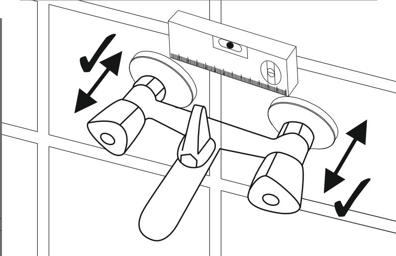
**Es ist darauf zu achten, dass die Armatur waagerecht und nicht verkantet montiert wird.
