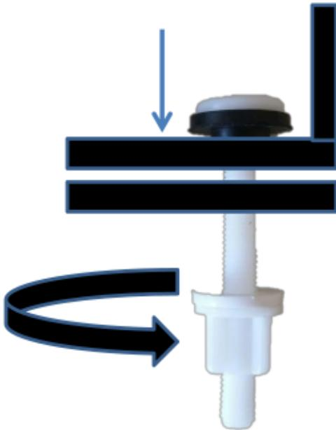
Verbinden Sie das Stand-WC mit dem Spülkasten mit den dafür vorgesehenen Befestigungsschrauben (Nr. 6) . Achten Sie darauf das die Dichtung innen liegt.
