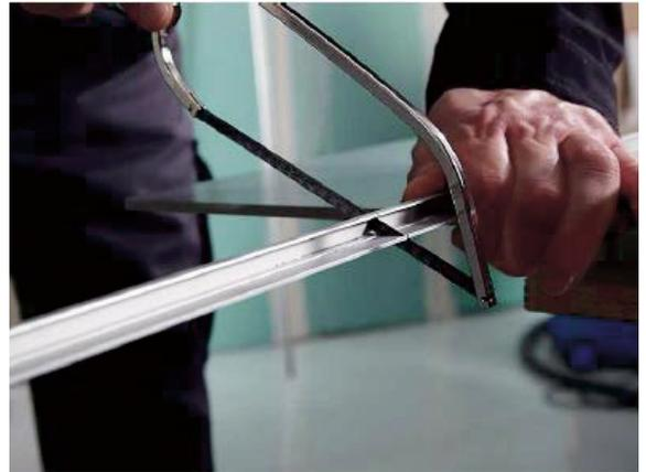
**3.11** Im nächsten Schritt müssen die von Ihnen verwendeten Profile auf Plattenmaß gesägt werden.
