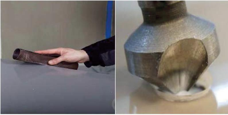
**3.6 Alle** Kanten, Ausschnitte und Bohrungen entgraten bzw. anfasen. Zum Entgraten der Kanten verwenden Sie bitte das im Lieferumfang enthaltene 120er Schleifpapier.
