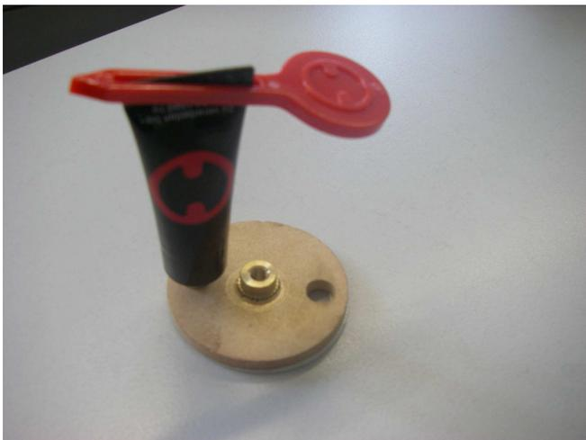
Befüllen mit Kleber bis aus der 2. Bohrung der Kleber austritt.
