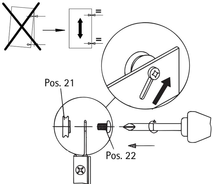
Durch die Bohrungen in der oberen Querstrebe lassen sich die Türen nachstellen. Dazu die Schrauben der Laufrollen lösen, Tür so ausrichten, dass sie von oben bis unten gleichmäßig schließt. Dann Schrauben der Laufrollen wieder fest anziehen und Öffnungen mit den Abdeckkappen Pos. 34 verschließen (eventuell mit etwas Silikon).
