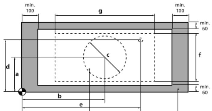
Ab einer bestimmten Ausschnittgröße wird aus Sicherheitsgründen nur vorgefräst da sonst Bruchgefahr bei Transport besteht.
